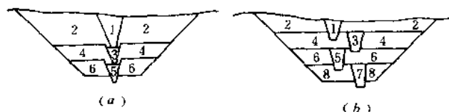
图 1-2 分层下挖法 (a) 中心排水沟；(b) 翻滚排水沟 1~8—开挖顺序（1、3、5、7 为排水沟）
