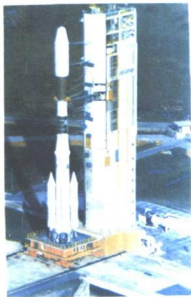
欧洲合作研制的带有两个液体和两个固体助推器的“阿丽亚娜”44LP型火箭。
