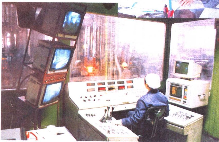
生产冲拉式无缝气瓶的 立式水压机计算机控制室
