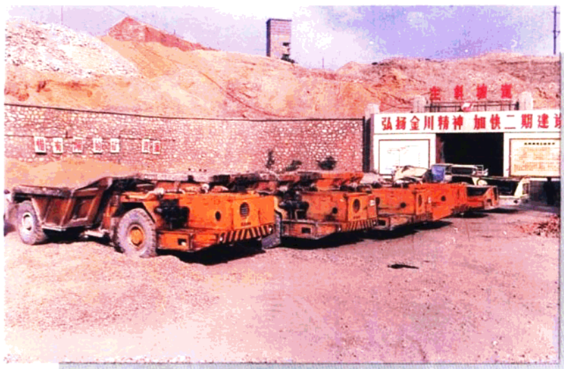
金川二矿区 1679 斜坡 道口的 MK-A25.5(25t) 井下卡车及 6m 3 铲运机
