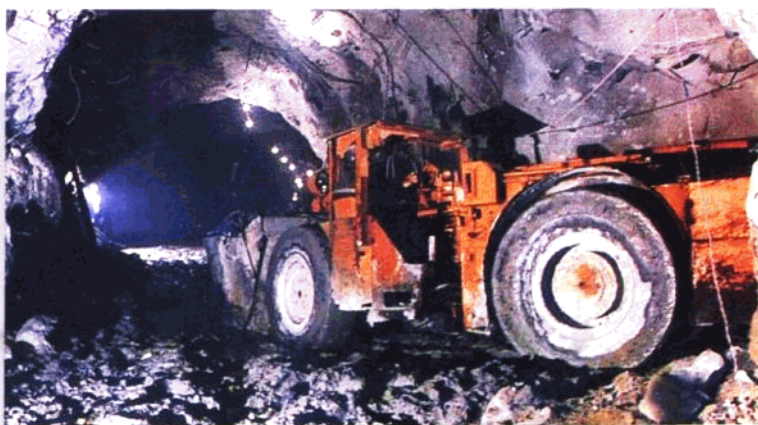
金川二矿区 1400 中段采用 LF4.1 铲运机进行出矿
