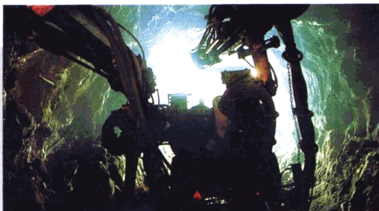
金川二矿区 1250 中段采用 H —127 凿岩台车在下向胶结充 填法采场中凿岩
