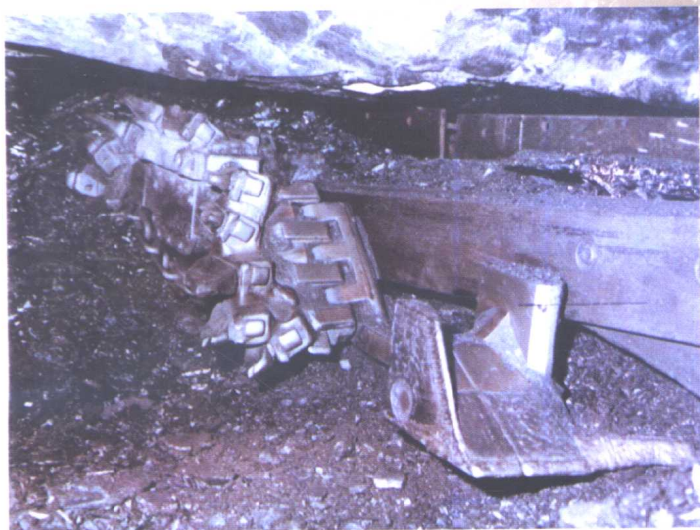
彩图 1 刨煤机在薄煤层工作面工作
