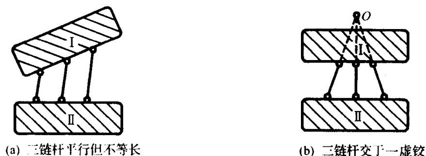
图 1.8 两刚片由三链杆组成瞬变体系
