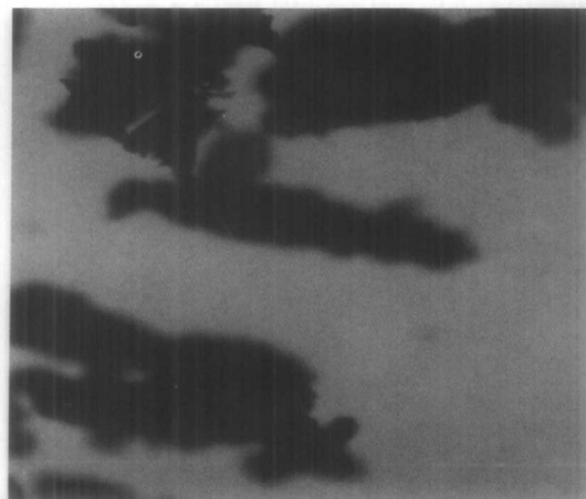
照片 30 橡胶材料的典型磨屑图 (a)SBR( N=12N, T_r=450r ); (b)NBR( N=8N, T_r=1350r )
