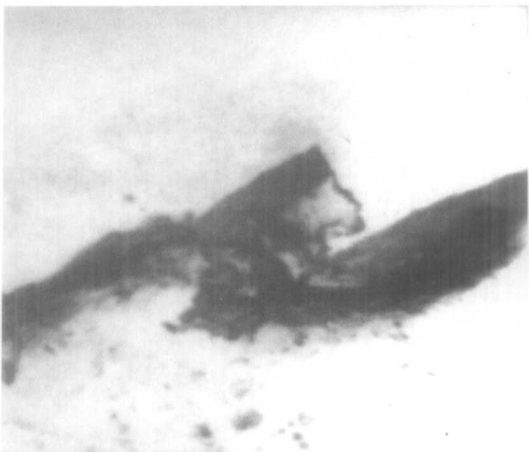
照片6 填充丁腈橡胶形成磨损花纹的过程 (横断面, W=1.5\text{kJ/m}^2 ) (a)舌状物形成; (b)舌状物断裂
