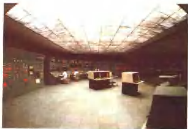
北京电力学校 1983 年在我国最先引进的 300mw 火电机组全仿真模拟机
