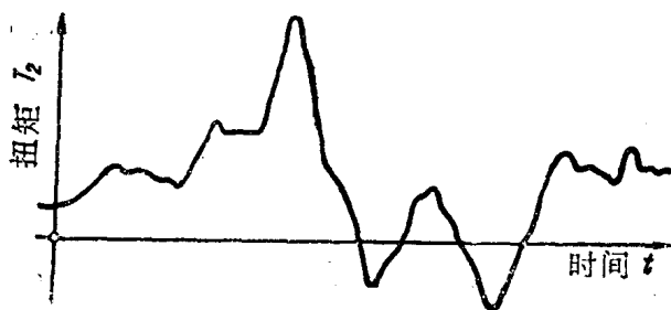
图 2 取作为时间 t 函数的扭矩 T (载荷 T ) 曲线之一段
