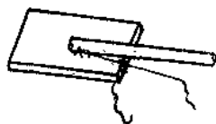
图1—5 钢筋与钢板的搭接连接
