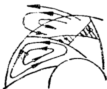
图 1-1-4 混流泵叶轮内的二次回流
