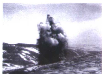
在海拔 4730m 高原冻土地区进行冻土爆破试验
