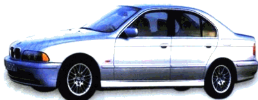
↪ 5 系列 最高时速:280 千米 最大马力:400 匹 排气量:2793 毫升 耗油量:18L/100 公里 国内市场价:80 万元人民币
