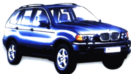
↪ X5 最高时速:202 千米 最大马力:286 匹 排气量:2979 毫升 耗油量:15L/100 公里 国内市场价:75 万元人民币
