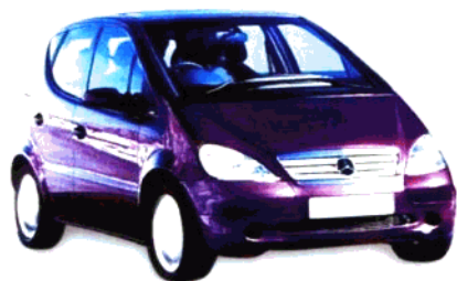
♪ A160 最高时速:198 千米 最大马力:125 匹 排气量:1598 毫升 耗油量:7.21/100 公里 国内市场价:38 万元人民币
