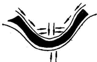
图 1-1 向斜构造应力集中
