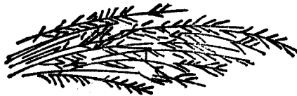
(f) 灰口铸铁:火束短而细,流线呈暗红色,尾端下垂,有羽毛状尾花,光辉度增强
