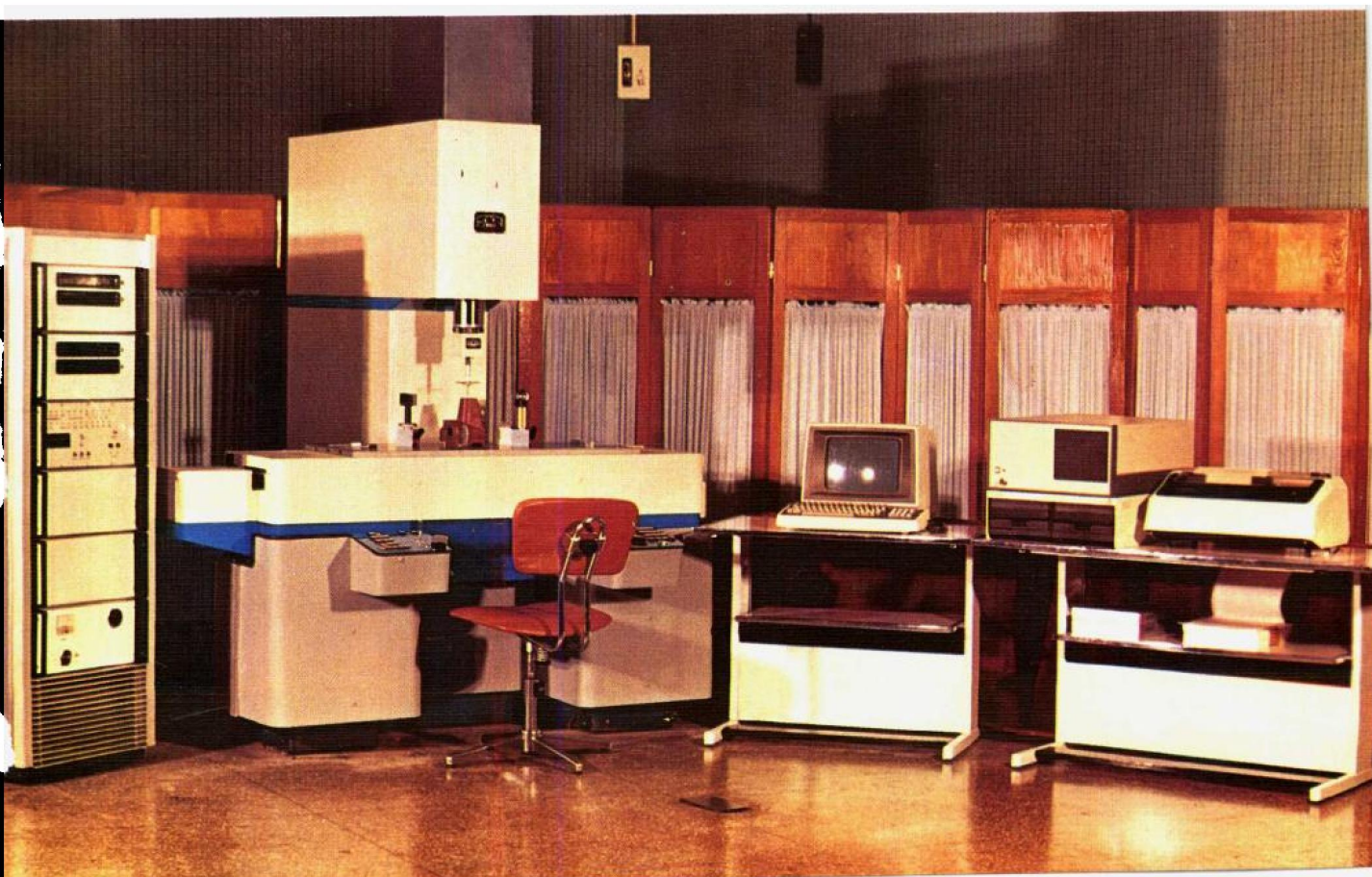
▼ 新天精密光学仪器公司制造的JS05型三坐标测量机 （机械工业部供稿）
