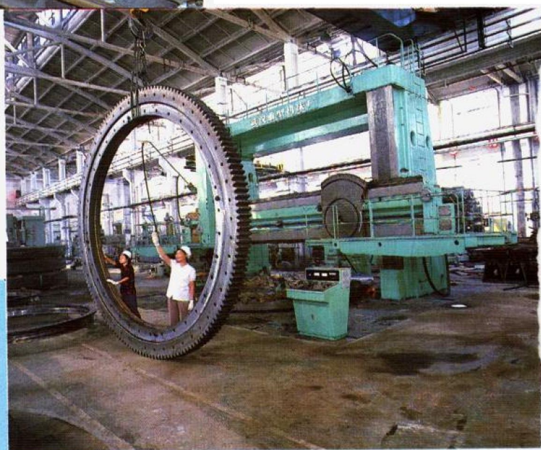
▶ 洛阳轴承厂生产的特大型轴承 (机械工业部供稿)
