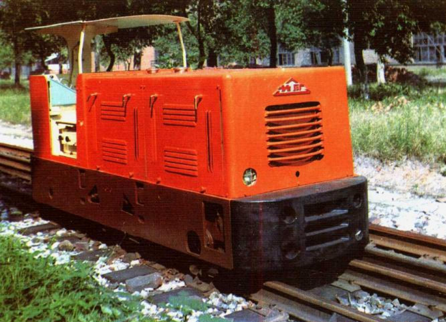
◀ 长沙矿山通用机器厂 研制的 JX40KB 型低污 染防爆内燃机车
