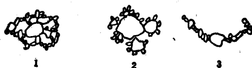
图 1-1 粉尘粒子凝结时的结构形式
