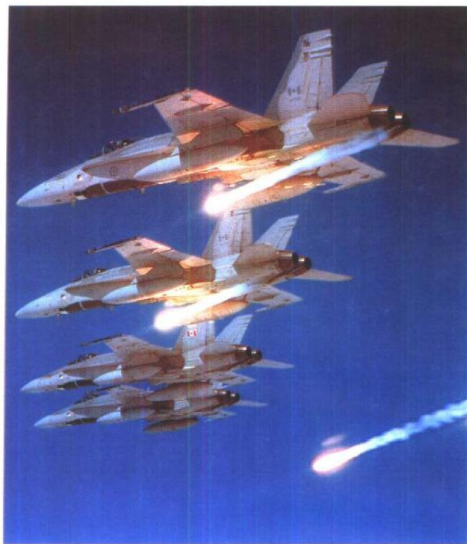
来自第433中队的加拿大CF-18飞机在北约演习中投掷照明弹。注意在每个飞机底部的假座舱盖，所有CF-18飞机都装有这种欺骗伪装装置。(麦克·雷诺/空中技术图片社)
