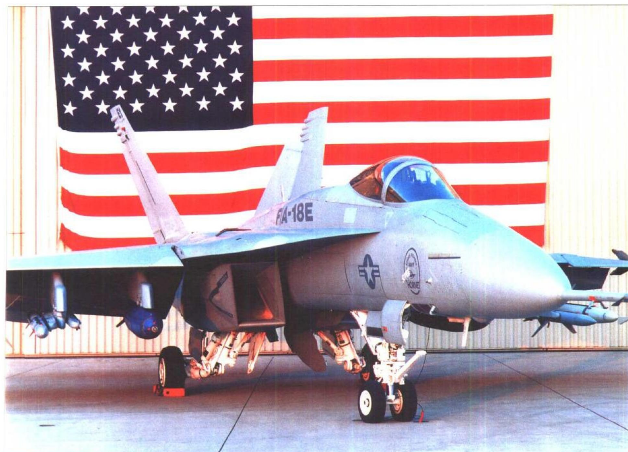
第一架工程制造发展型F/A-18E(编号 165164)。注意在右侧中间挂架上的AIM-120C导弹。(波音公司可文·福莱恩摄影)
