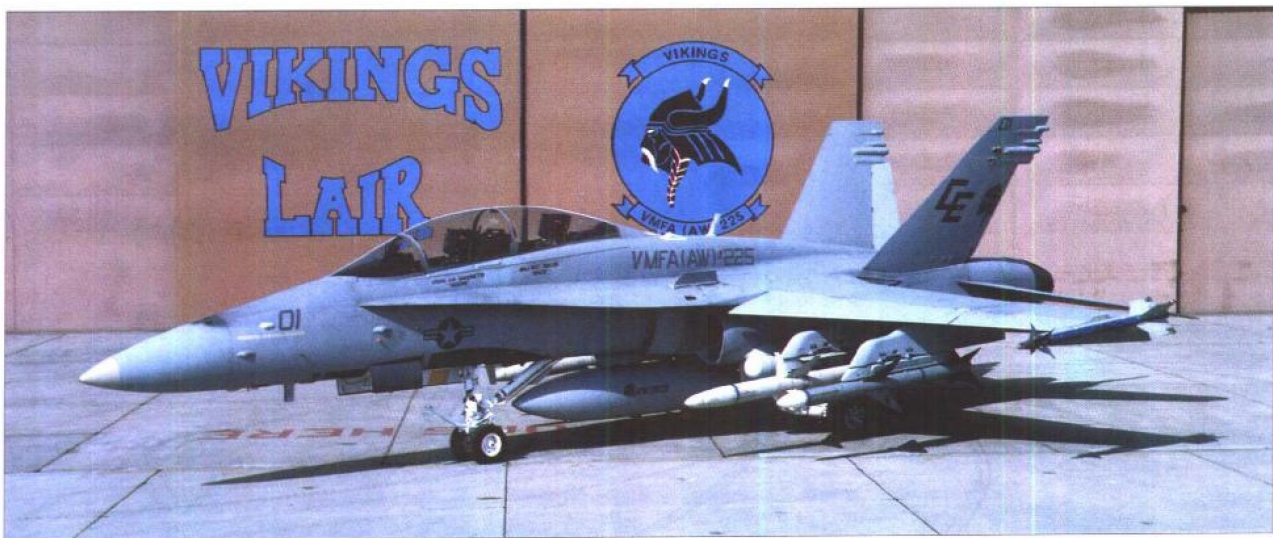
有几个海军陆战队的全天候攻击中队使用F/A-18D飞机, 其中包括图中的VMFA(AW)-225中队。注意在前机身底部的假座舱盖。这张照片也显示了AGM-88“哈姆”导弹(在内侧挂架上)和AIM-7“麻雀”导弹(在外侧挂架上)之间的尺寸差别。(罗伯特 L. 劳森通过麦克·罗斯收集)
