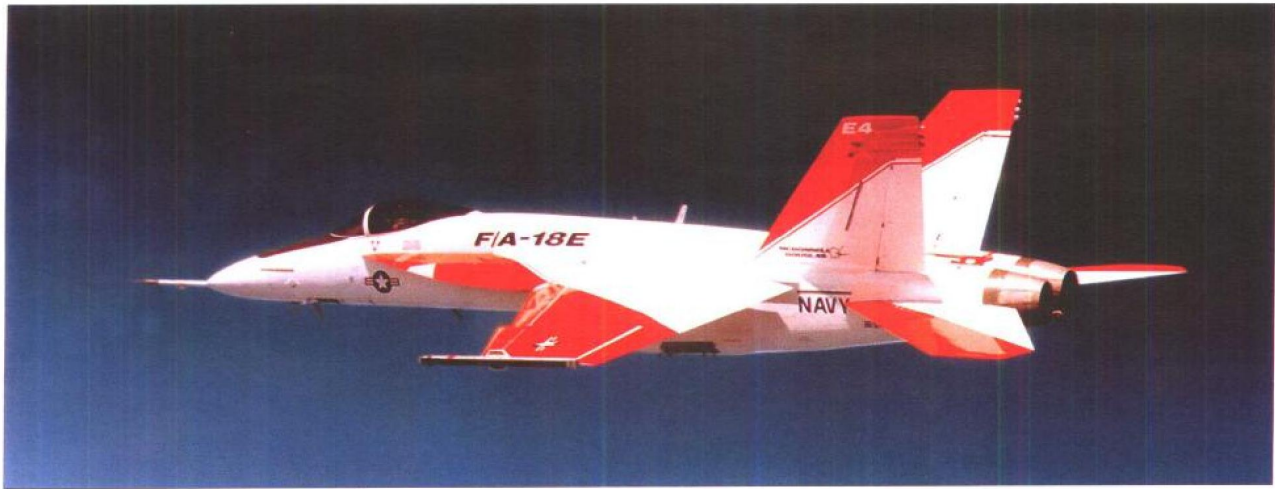
第四架工程制造发展型“超级大黄蜂”(编号 165168), 将用来研究E/F型飞机在大攻角下的性能。注意在垂尾之间后机身上面的螺旋改出降落伞的安装位置。(波音公司)
