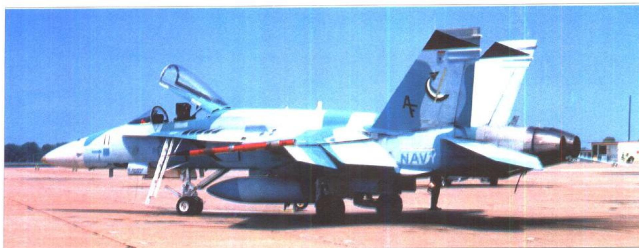
1995年8月31日，这架VFC-12中队的F/A-18A在奥辛纳海军航空基地展示了另一种“入侵者”涂装。仔细观察可以发现一些试图使该机看起来像俄罗斯战斗机的细节——垂尾顶端的黑色“三角标志”、前缘延伸边条顶端的“百叶窗形进气口”等。(克莱·卡斯頓经麦克·罗斯收集)
