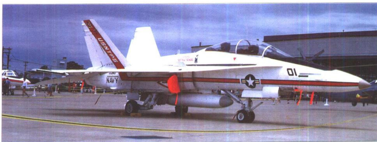
美国海军试飞员学校使用了4架“大黄蜂”，它们有着非常吸引人的带有红色修饰的白色涂装方案。注意在1989年5月，这架F/A-18B(编号 161248)飞机中心线挂架下挂载早期设计的椭圆形截面副油箱。(麦克·罗斯收集)
