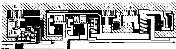
图 1-8 2 档齿轮（换挡杆置 D 位置）传动结构简图
