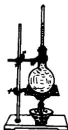
图 1-2 液体的热膨胀
