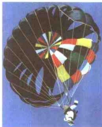
降落伞降落的速度很慢,这是因为伞囊兜住了空气。降落伞的这种形状会产生很大的阻力。
