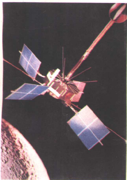
◀ 人造卫星上的太阳能电池
