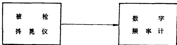
图3 振荡器输出频率检定连接图
