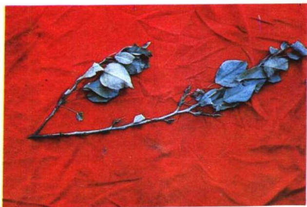
图7 一枝枯树枝造成高压短路
