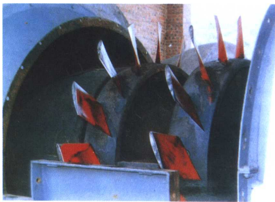
永荣矿务局生产的双曲线变截面轴流风机叶片
