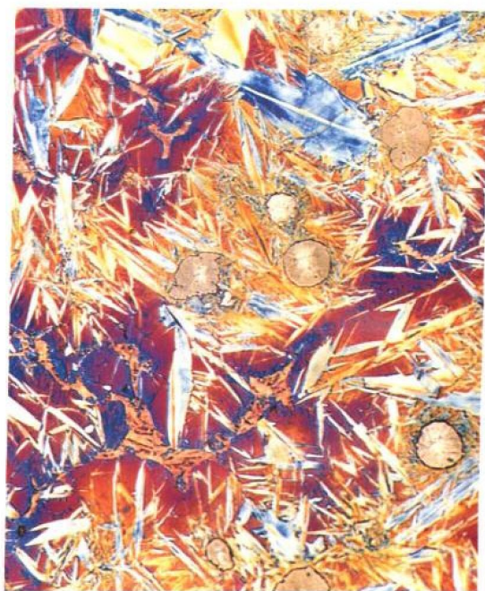
图 15-7 球墨铸铁淬火组织, 热染, 组织为马氏体 + 残余奥氏体 + 磷共晶。500×
