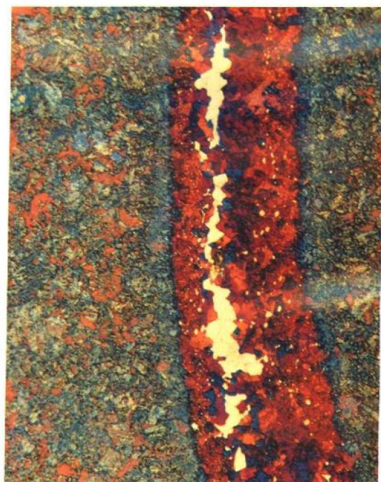
图 15-8 40MnB 钢锻造后调质处理, 4% 硝酸酒精预浸蚀后热染, 基体为回火索氏体, 红色带为折迭。400×
