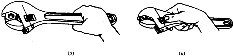
图 1.1-7 活络扳手的握持法 (a)扳动大螺母;(b)扳动小螺母
