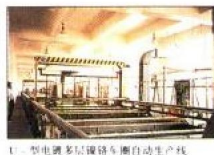
1. 型电镀多层电路板自动生产线
