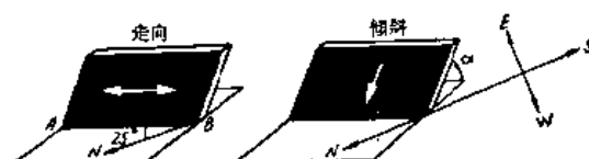
图3 煤层的走向和傾斜
