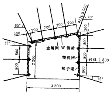
图 3 1 号煤层全锚支护巷道断面图
