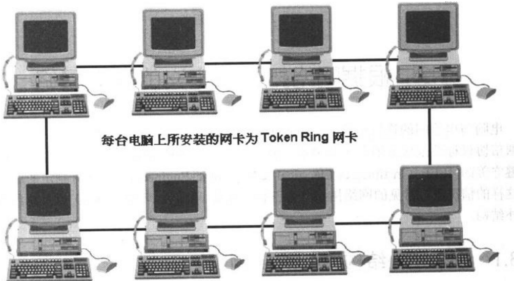
图 1-4 环型拓扑结构的网络联机结构图
