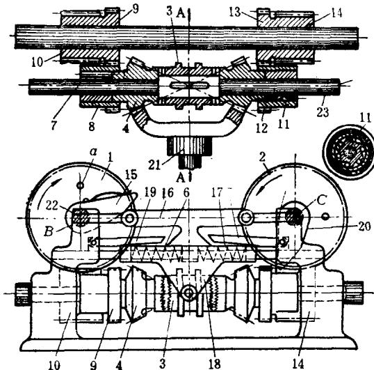
原动轴21绕其轴线A-A转动。当离合器3与轮4接合（构件5支持离合器在左面位置）时，通过轴23、超越离合器7、齿轮8、9和蜗杆10，使蜗轮1转动；此时蜗轮2停转，因超越离合器11的星轮和外圈处于分离状态。当轮1上销a转至与活套在轴22上的构件15相遇，构件16在构件15的作用下向右移动，压缩弹簧17。在该弹簧作用下，构件18抬高构件5，使离合器3换向；此时构件19支持该离合器在右面位置，轮1随之停转，而通过超越离合器11、齿轮12、13和蜗杆14，使蜗轮2转动，直至构件20与构件16相遇，推动其向左移动。构件18在弹簧6作用下使离合器3换向，又重复上述运动过程。
