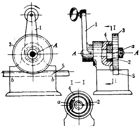
手柄1和与它刚性连接的齿轮3绕定轴线A转动。齿条5和轮3啮合并沿导轨6-6作直移运动。螺旋弹簧4与轮3轴的轴承毂体紧密地邻接，弹簧的弯曲的末端位于盘2的切口a中，盘2和轮3的轴刚性连接。当在箭头所指方向转动手柄1时，盘2的切口扭转弹簧4，这时弹簧直径减小，并且手柄的转动传递给轮3，使齿条5运动。当反方向转动手柄时，盘的切口从另一方向扭转弹簧，弹簧和轴承毂体间的摩擦力使弹簧直径扩张并压紧在轴承毂体上，妨碍轮3转动和移动齿条。
