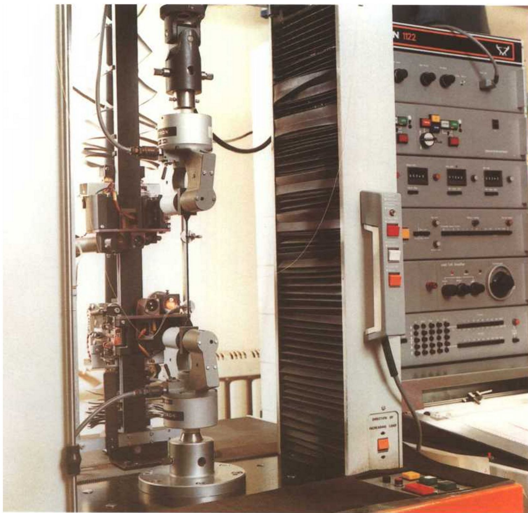
在试验室对塑料的抗拉强度进行检验
