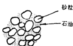
图2 石油在砂粒之间的 孔隙中聚集起来
