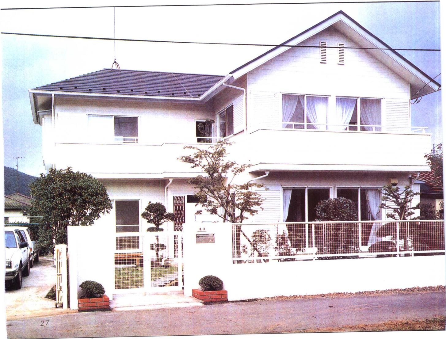
考虑与将来周围环境协调,建筑体型变化比较丰富,开窗面积较大,墙面采用水泥石棉板,结构为木结构。
