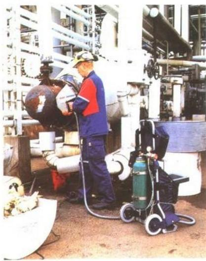
OES—直读光谱分析, 具有非常高的准确度和重复性, 即使对轻合金元素的分析(Al、Si、Mg 和 C)也是如此, 碳的分析精度之高, 可以区分 316/316L 不锈钢。用同一套硬件可以分析钢中的 S.P..
