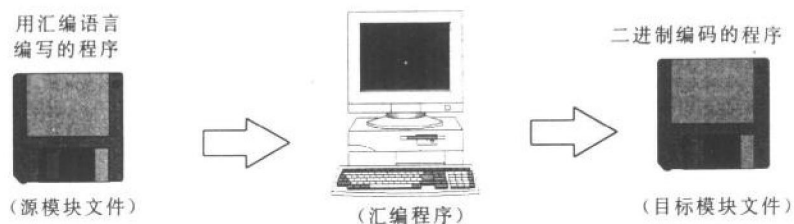
图 1-2 汇编程序的流程
