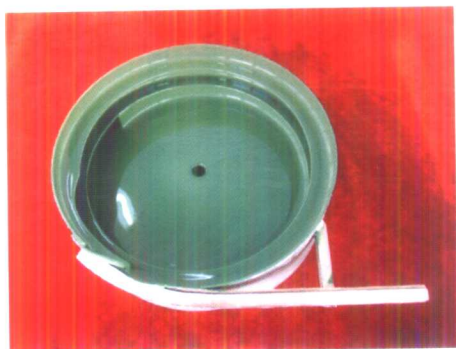
图 20-11 SPUA 技术用于振 动盘耐磨衬里
