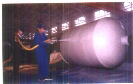
图 20-13 SPUA 技术用于大 型码头护舷的制作
