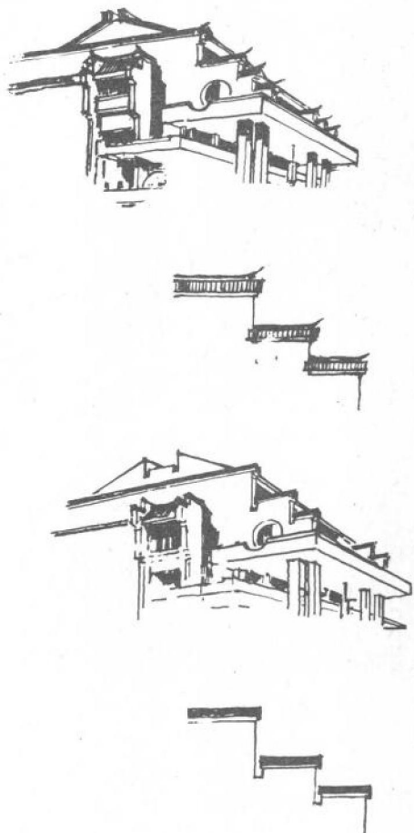
图 11 山墙—马头墙在施工中被进一步简化。这不是由设计者对这种“片断”的好恶造成，而是当代材料、技巧和效率所使然
