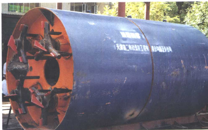
货厂大街排水工程 (土压平衡式顶管施工)
