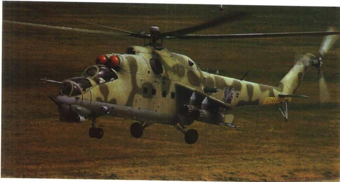
苏联米里直升机实验设计局设计的单旋翼带尾桨双发动机多用途攻击武装直升机。是苏联的第一代专用武装直升机，包括出口型有15种型号，共生产了2500架。它装有2台1640千瓦苏制TV3-117航空涡轮轴发动机。
