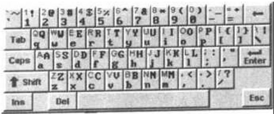
要想从键盘上输入汉字，必须将每个汉字对应键盘上的某些键（通常用字母、数字键）。以一定的规则将所有汉字与字母、数字对应起来，就是将汉字进行编码。例如：按汉字拼音编码可将“好”字对应为“hao”；按五笔字型编码规则“好”字则对应为“vbg”。这样我们就可以按汉字编码从键盘输入汉字了。汉字输入法软件会让计算机识别你输入的编码是什么汉字。
