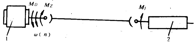
图 10-1 工作机械通过电动机直接驱动的电力驱动系统 1—电动机; 2—工作机械
