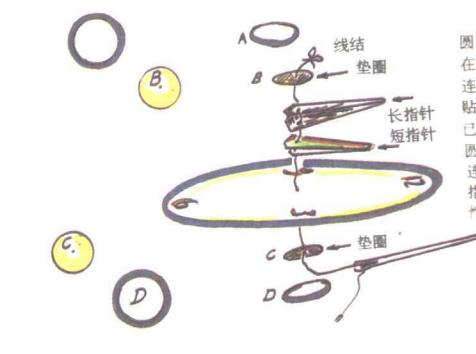
先在线端打结，再将线穿过圆B、指针、钟盘、C圆，将线结在B圆上拉至尽头，在B圆上连同线结一起抹上胶。用A圆贴紧在B圆上。最后将B圆(A已贴在B上)、指针、钟盘及C圆一并压紧，再在C圆出线处连同线一起用D圆贴紧。注意：指针不要用力折，以便留有弹性。
