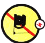
禁止架通信线
