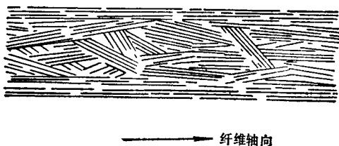
图1-2 成纤高聚物在纤维中排列状态
