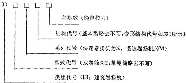
注：快速系列卷扬机基本型结构为采用圆锥摩擦离合器并作用在卷筒上。
