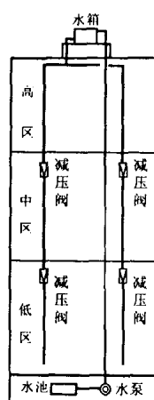
图2-6 沿垂直立管循序 减压给水方式
