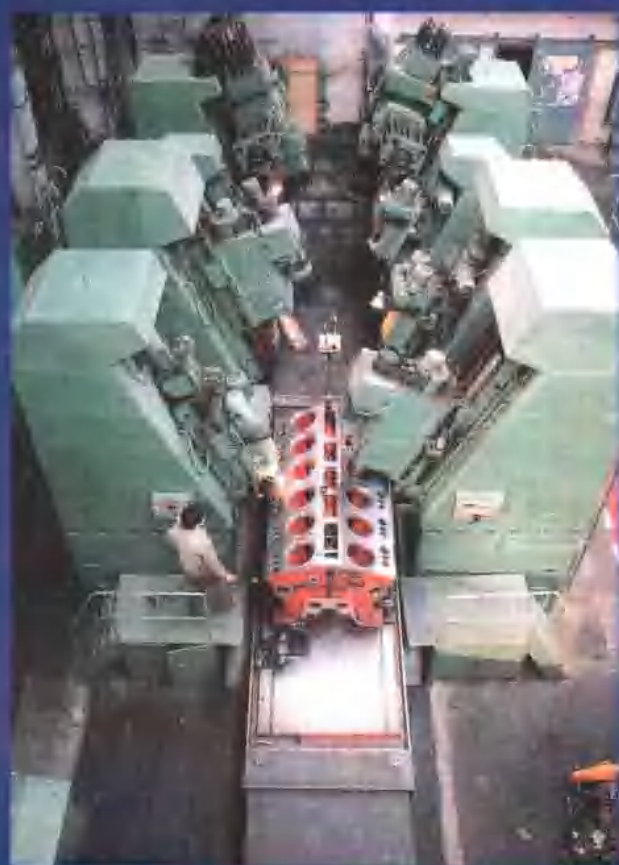
北京二七机车厂自行设计制造的12240型柴油机体加工专用机床,由镗、钻、绞、扩等八台机床组成,长18米,总重300余吨。
