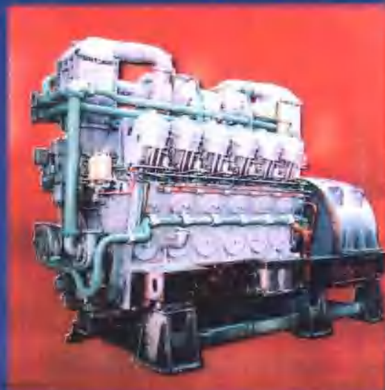
北京二七机车厂自行设计制造的12240型柴油机,用于北京型、东风7型及小调GK 1 型等内燃机车。
