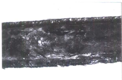
图 4-2 腐蚀破裂爆口
