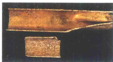
图 5-6 铝黄铜管端冲击腐蚀(上) 和管内冲击腐蚀(下)
