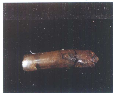
图 5-4 70-1.5A 铝黄铜管的晶间腐蚀
