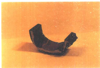
图 4-4 酸腐蚀脆爆管样
