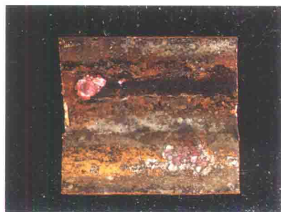
图 5-5 铝黄铜管的沉积腐蚀
